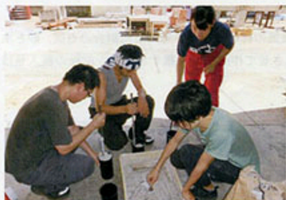
写真7 シリンダに入れて突く
