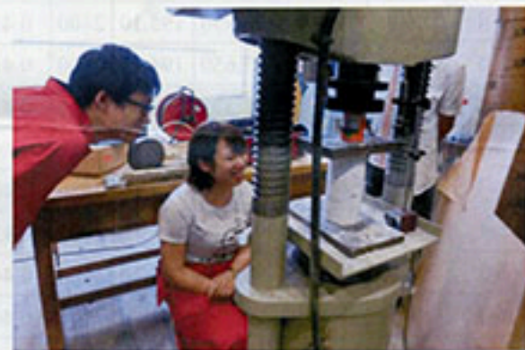
写真 18 圧縮強度試験/実験の様子
