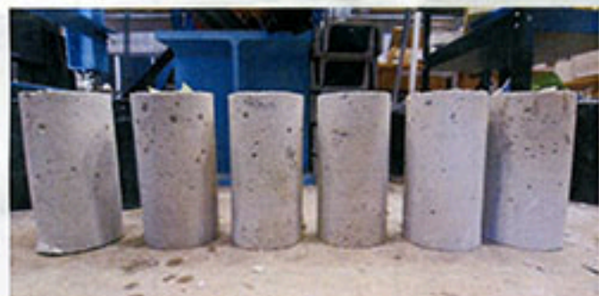
写真13 脱型した試験体
