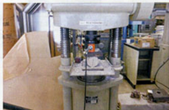
写真 19 割裂引張強度試験/設置
