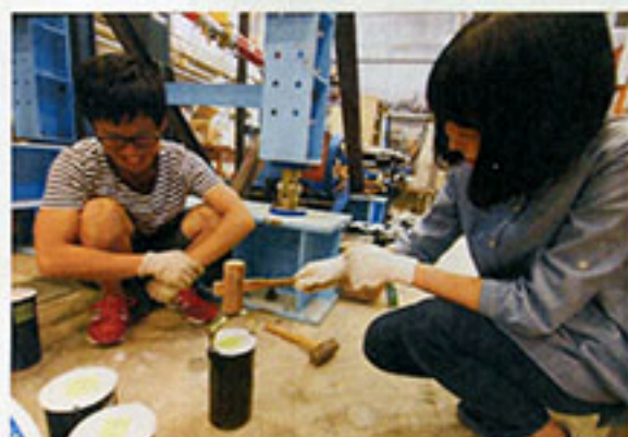
写真11 シリンダ型 (ヒットワン) を叩いて脱型
