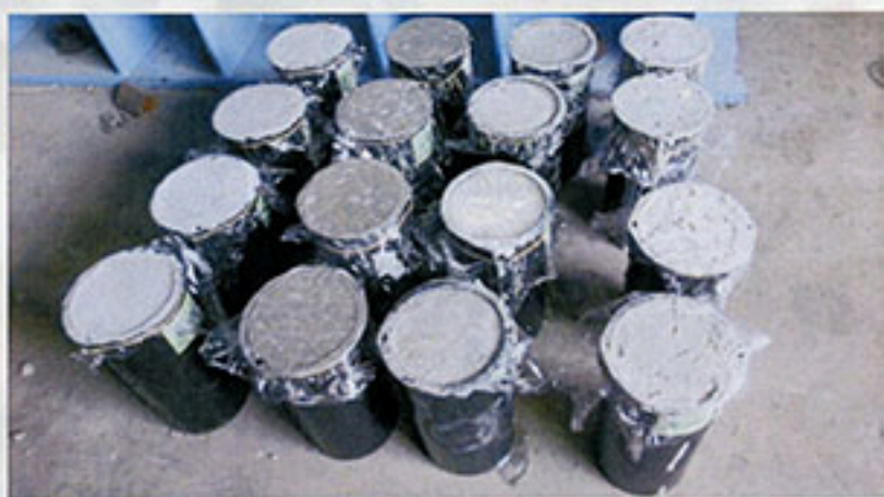
写真10 ラップをして1か月間養生する
