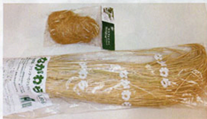
写真3 混入させる材料（上：ヤシ繊維、下：藁すき）
