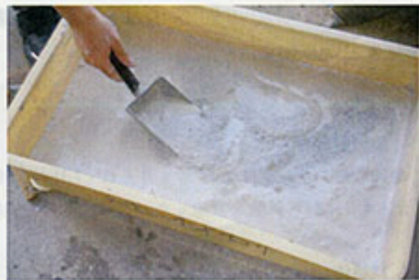
写真6 混ぜる（水分が多すぎる状態）
