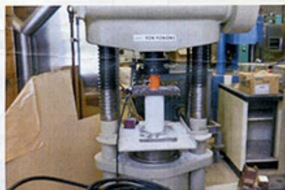
写真 17 圧縮強度試験/設置
