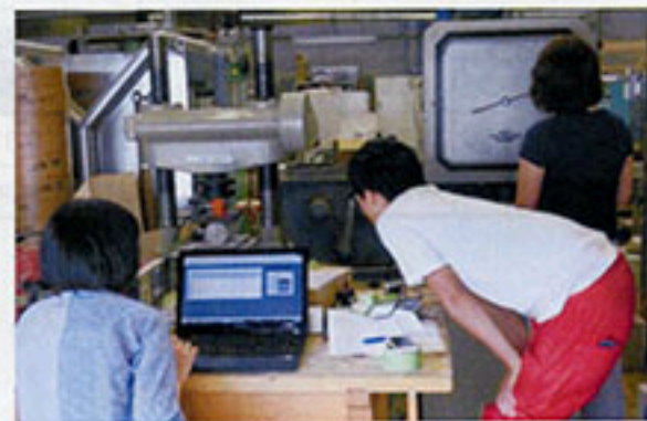
写真 20 割裂引張強度試験/実験の様子
